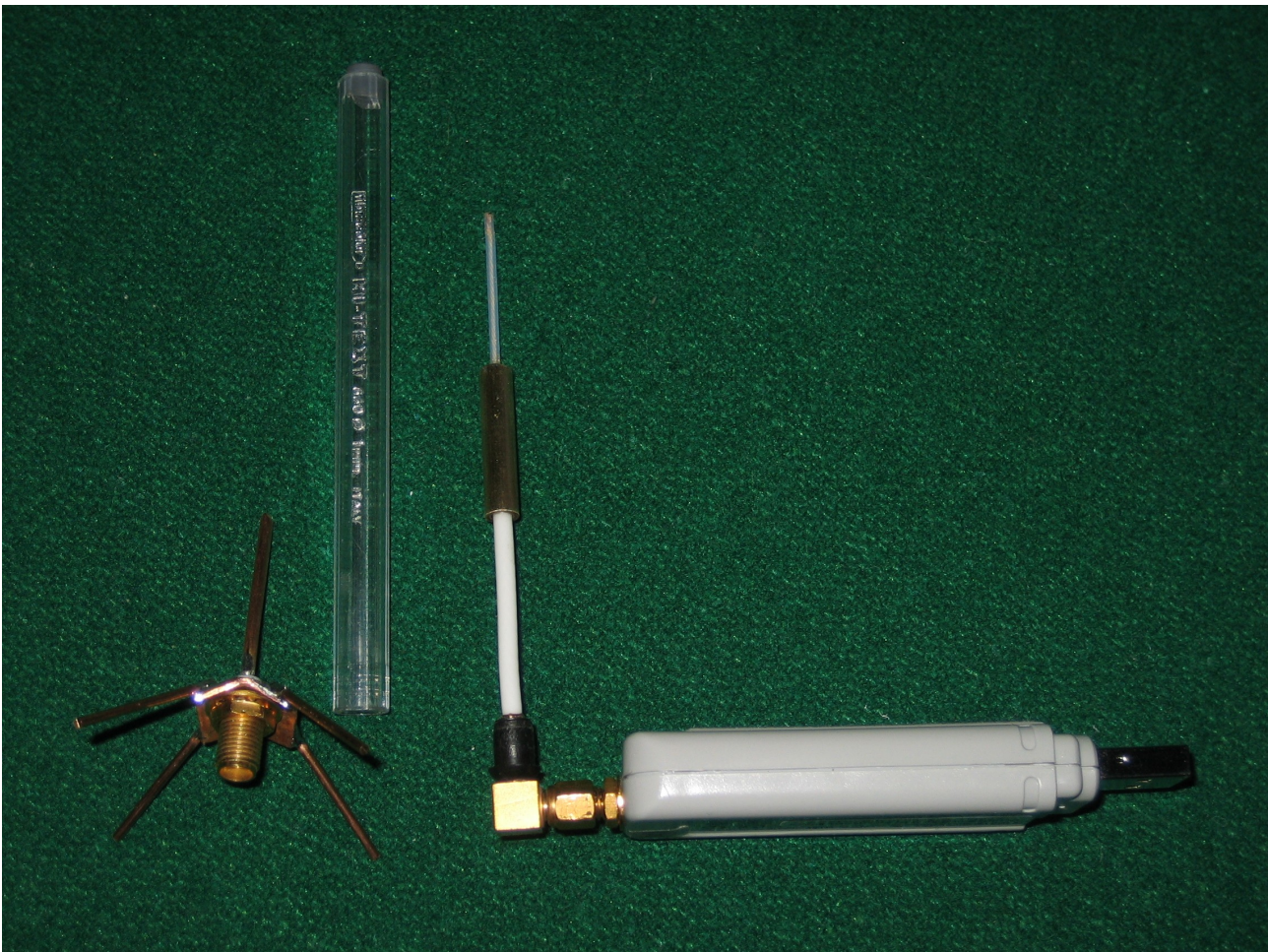
Esempio di ground plane e di dipolo coassiale messo in contenitore di penna a sfera
